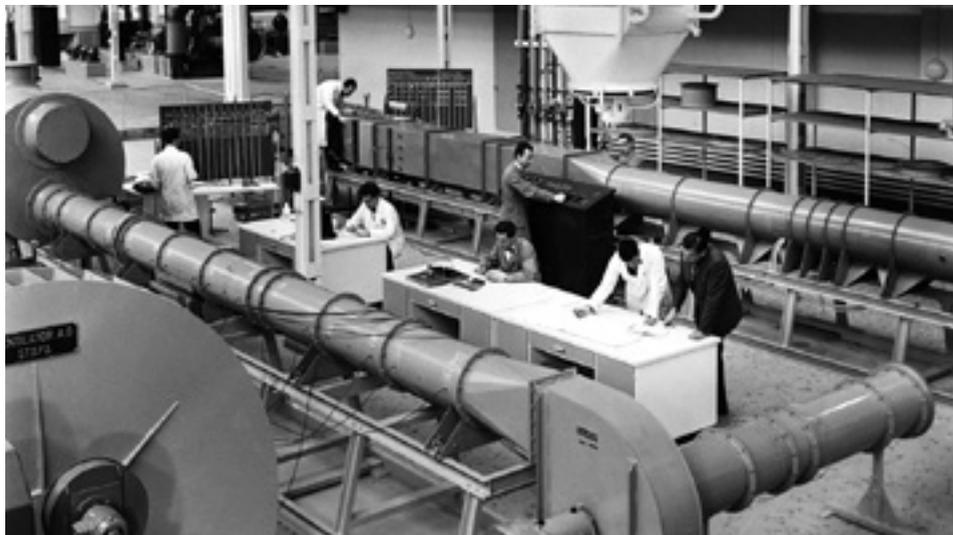
Lüftungslabor mit Radialventilatoren- und Wärmeaustauscher-Prüfstrecke (Ende der 1970er-Jahre).
